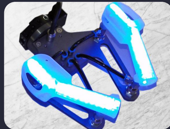
Etude et réalisation d'un Préhenseur robot de démonstration
